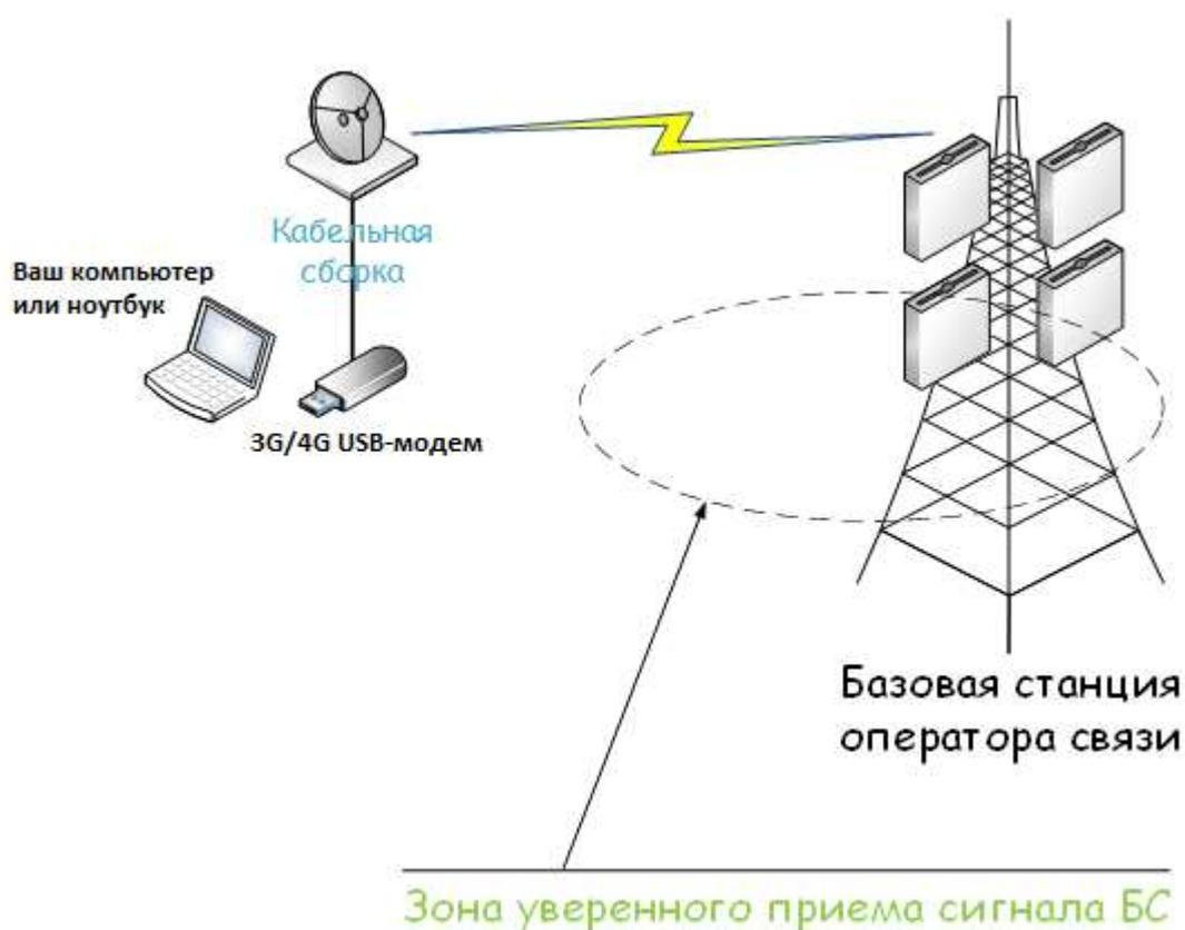
Принцип работы: в месте наилучшего приема сигнала (на крыше, на фасаде здания или за окном) устанавливается направленная антенна, ориентированная на базовую станцию оператора 3G/4G.
